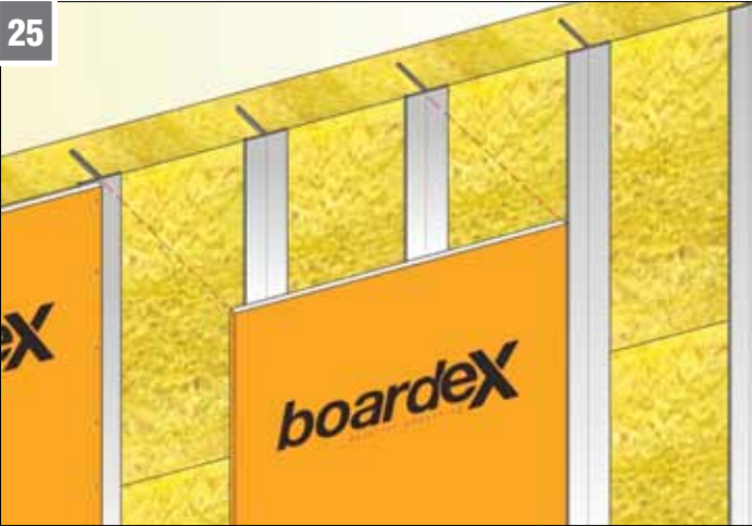
Boardex'in sabitlenmesi Boardex, CT profillerin kanadını ortalayacak şekilde yerleştirilir.
