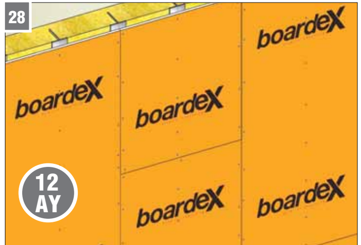
Boardex'in sabitlenmesi Terazi ve şekline alınmış mükemmel Boardex yüzeyi, üzerine uygulanacak kaplama malzemeleri için hazır hale getirilir. Boardex yüzeyi üzerine herhangi bir kaplama yapmadan 12 aya kadar dış hava koşullarında bırakılabilir.
